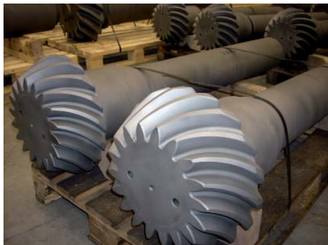
Råämnen, innan bearbetning påbörjats... ATA tillverkar kuggar från 100mm diameter upp till massiva 2300mm.
