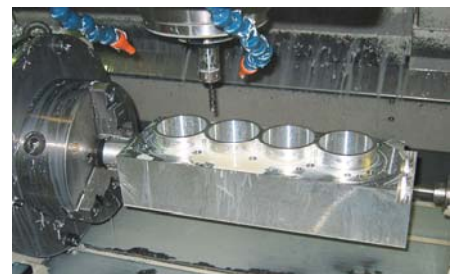
Bearbetning i en Cincinnati, 4-axlig fräs
