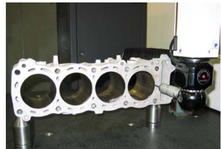
Uppmätning av originalcylinder i mätmaskin
