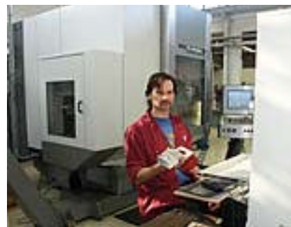
Elis Spets gör hela CAM-beredningen direkt från solidmodell på en dator på Verkstadsgolvet – och simulerar resultatet på skärmen.
