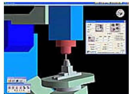
Samma detalj simulerad i den maskinsimulator som Fructus byggt speciellt för Deckel Maho DMU50e-maskinen och som bl.a. kollisionssimulerar verkliga rörelser.
