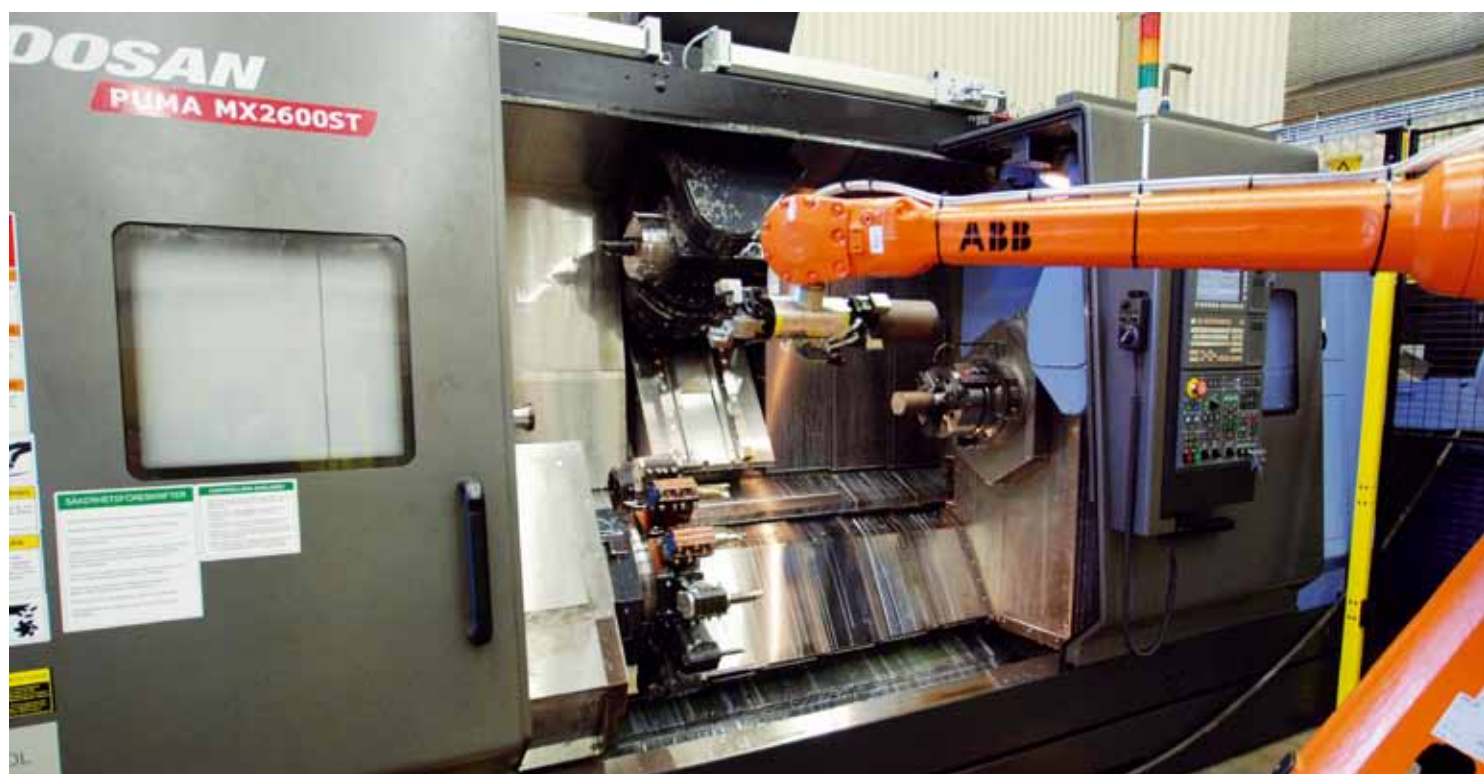
En Doosan Puma MX2600 multimaskin för svarvning och fräsning som laddas av robot. Lisjö Produktion har två likadana robotceller. Mätutrustningen är ett viktigt konkurrensmedel.
